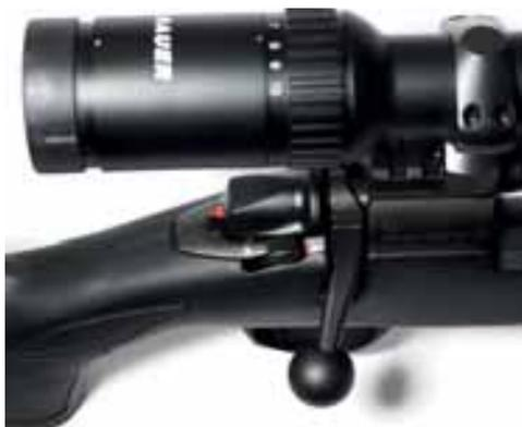
Die rote Spannanzeige an der Kammer ist sicht- und fühlbar. Die Zweistellungs-Sicherung sperrt die Kammer in gesichertem Zustand (links) nicht und kann praktisch geräuschlos entsichert werden (rechts).
